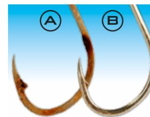
Sopra, il risultato di una prova comparativa: un amo tradizionale in acciaio al carbonio, semplicemente nichelato (A) e un 5314-ARC protetto contro la corrosione (B) dopo la permanenza in acqua di mare per due mesi. Il nuovo 5314 avrebbe potuto resistere ancora!
